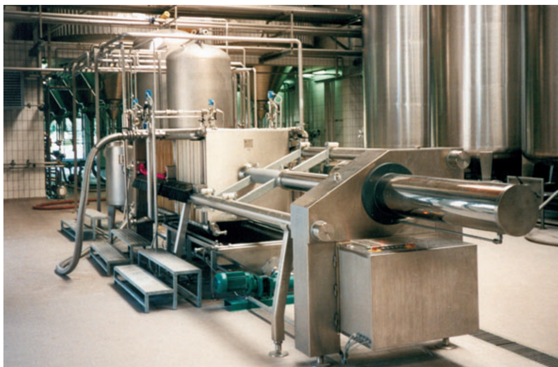
SF 1000B mit Kieselgur-Austragsvorrichtung
